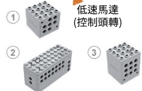
① 低速馬達 (控制頭轉) ② 主控器 ③ 高速馬達 (控制前後左右)
